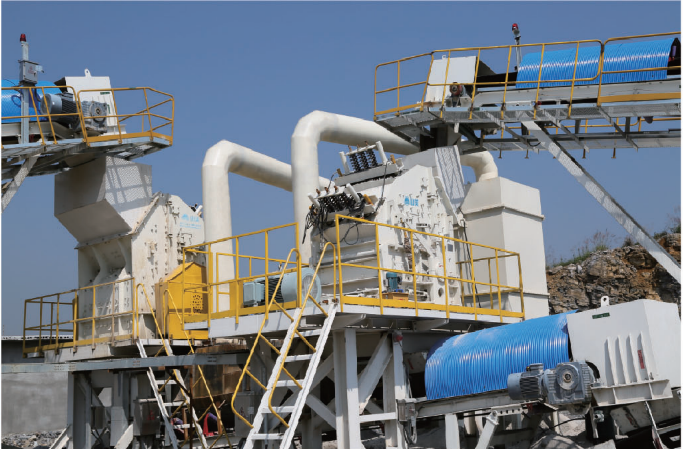
贵州拉法基项目现场 Lafarge Project in Guizhou 反击式破碎机 Impact Crusher
