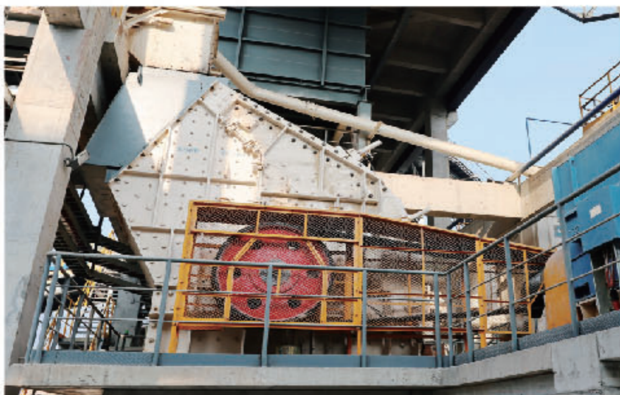
华新水泥（长阳）项目 Huaxin Cement Project HC798 反击式破碎机 HC798 Impact Crusher
